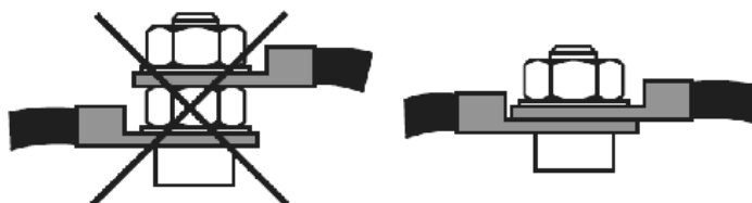
Illustrazione 2 Montaggio corretto dei pattini della forcella ad anello
