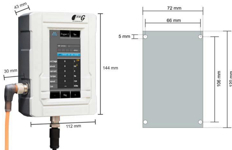
Figuur 11: Afmetingen van het HMI-bedieningspaneel en de metalen plaat
