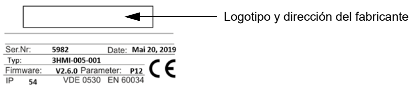
Figura 9: Ejemplo de una placa de características en el dispositivo de mando HMI
