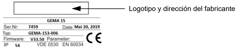
Figura 8: Ejemplo de una placa de características en la caja de controlador GEMA
