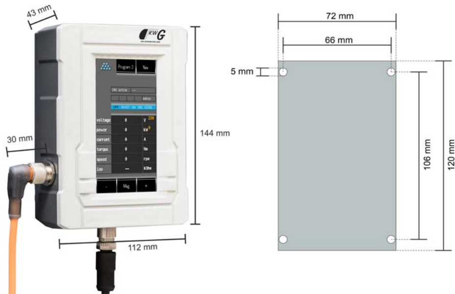
Abbildung 11: Abmessungen des HMI-Bediengeräts und der Metallplatte
